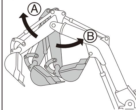
①のレバーを前に倒すとバケットがひらきます。手前に倒すとバケットがとじます。
