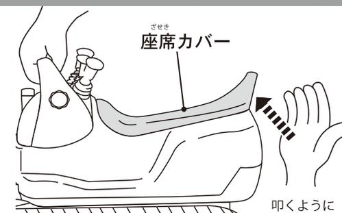
矢印の方向に強く叩くように押し上げて開けてください。
